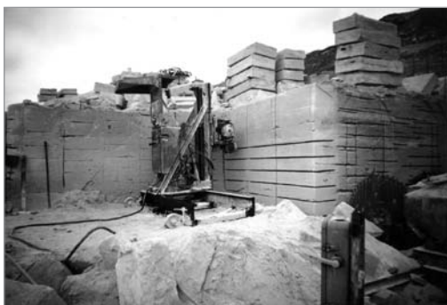
Добыча пильного камня-ракушечника в Григорьевском карьере.
