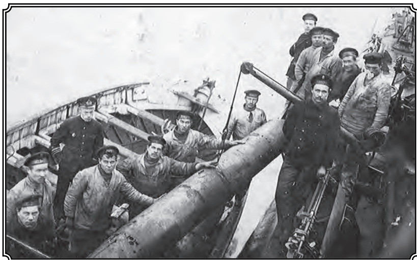
Погрузка торпед на подводную лодку «Леопард»
