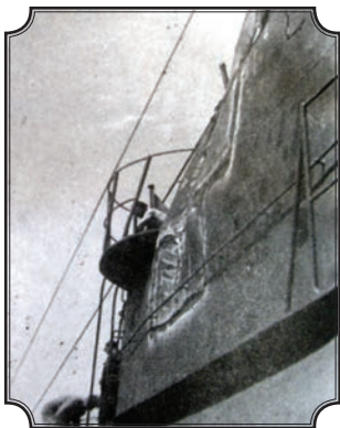
Повреждения ограждения рубки подводной лодки Л-23, полученные в результате столкновения с подводным объектом 18 июня 1942 года
