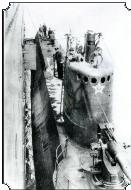
Ограждение рубки подводной лодки Д-4 после модернизации
